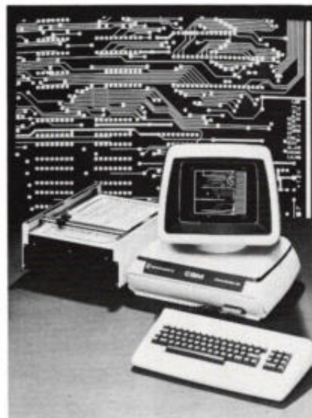
Afb. 10. Het printontwerpsysteem van Commodore. De plotter levert reproduceerbare printmaskers en het ontwerp wordt bovendien op diskette opgeslagen.
