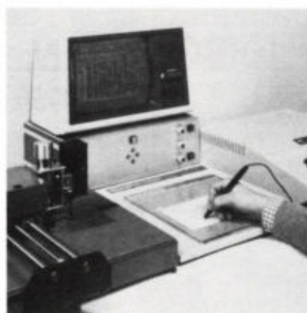
Afb. 9b. In het midden van deze foto ziet men het grafische tableau, met behulp waarvan de print wordt ontworpen. Links staat de computergestuurde freesmachine en rechts is nog juist de computer te zien.
